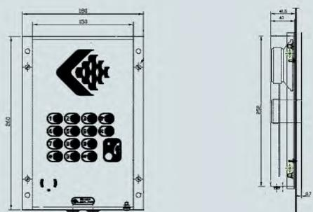
Новая гамма специальных асептических телефонов предназначена для работы в больницах и лабораториях. Данный телефон полностью герметичный и не содержит ни одного отверстия, что позволяет избежать накопления бактерий, вирусов или других микроорганизмов, которые могут являться причиной развития инфекции. Верхняя пластина из поликарбоната легко моется.
