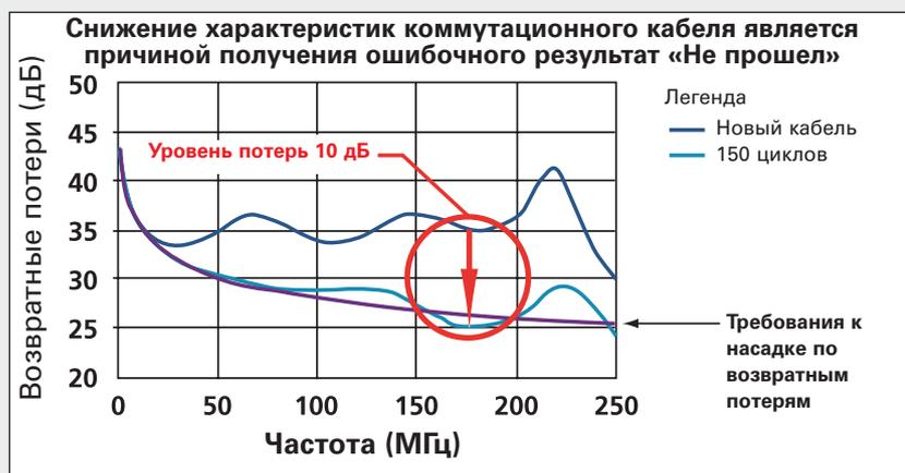
Как вы видите на графике, стандартный кабель SFTP категории 7 имеет уровень потерь 10 дБ после 150 циклов его скручивания-раскручивания. Из-за этих 10 дБ хорошее соединение определяется как плохое и как следствие выдается ошибочный результат «Не прошел». Это снижение характеристик не произойдет в случае применения технологии, используемой в насадках для «Постоянного соединения» от компании Fluke Networks – с DTX вы получаете неизменную точность и можете на нее положиться.
